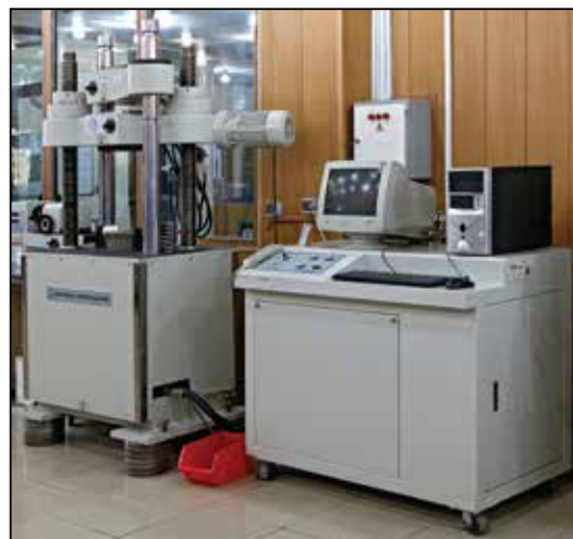
تست استحکام کششی و کاهش سطح مقطع
