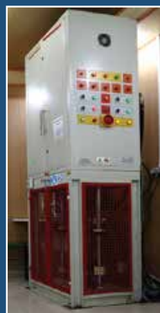
تست استحکام کششی و کاهش سطح مقطع
